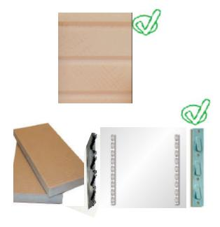
Como mínimo, hay que colocar dos tiras de guías, una en cada extremo de la estancia, pero es recomendable situar guías intermedias cada metro, para evitar que los cables se muevan o entren en contacto cuando se realice el extendido de la capa de hormigón.
