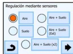
Escoja la regulación elegida apretando el botón redondo al lado de la oferta de las opciones de la regulación mediante sensores. El botón activo tiene el color rojo. Para continuar en el ajuste toque el botón ▶ en el ángulo inferior a la derecha del dispositivo. Para volver al menú anterior apriete el botón ◀.
