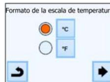
El formato de la escala de temperatura se elije apretando el botón redondo al lado del símbolo de la escala. El botón activo tiene el color rojo. Para continuar en el ajuste toque el botón ▶ en el ángulo inferior a la derecha del dispositivo. Para volver al menú anterior apriete el botón ◀.
