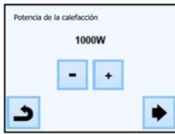
Modifique la potencia de la calefacción mediante los botones (+) o (-). El valor se utiliza para hacer la estimación de los gastos de calefacción y también en caso de que el sensor interior se utilice como sensor regulador (en la regulación Aire, Aire + Suelo y Aire + 2 suelos). Para volver al menú anterior apriete el botón . Para continuar en el ajuste toque el botón en el ángulo inferior a la derecha del dispositivo. Aparece la pantalla principal.
